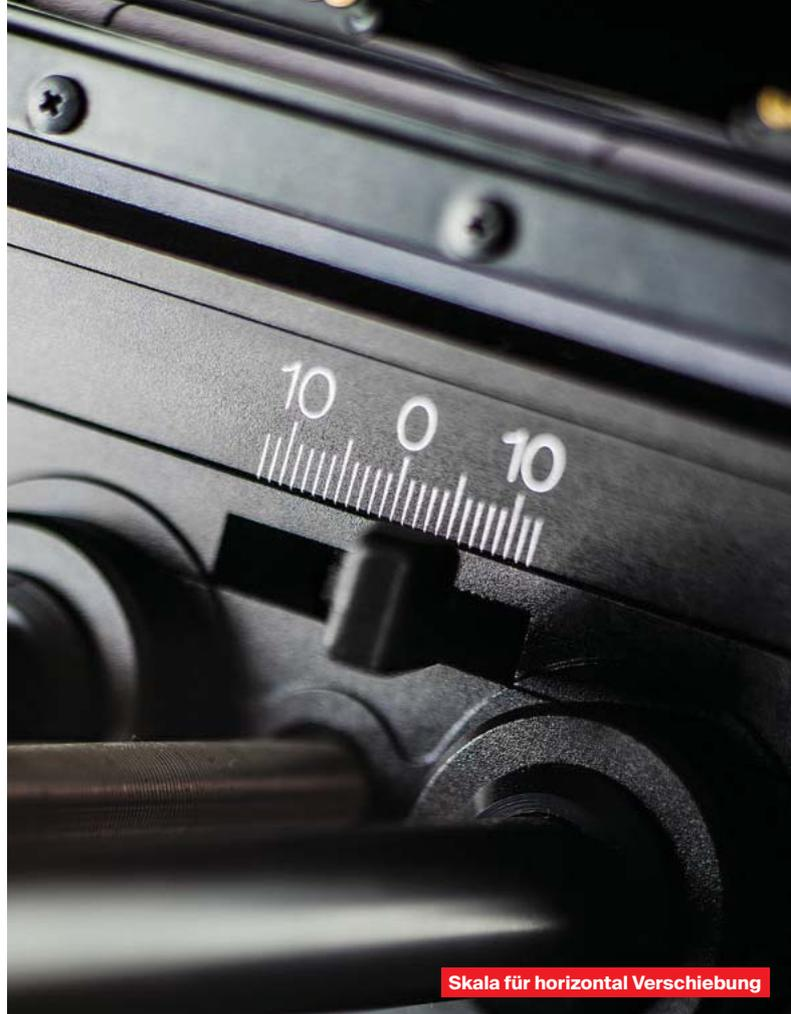
Skala für horizontal Verschiebung
